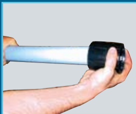
Ontbramen voor Ø 20 / 25 / 32 mm en schuin afkanten van de Ø 40 / 50 / 63 mm
