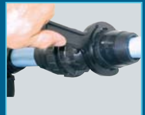
Met de speciale Quickair® sleutel of met een bandspantang de wartel 1/4 slag aandraaien
